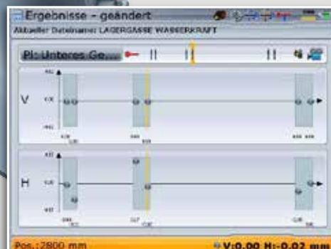
Los rodamientos desalineados generan tensiones mecánicas en el eje. Esto ocasiona vibraciones fuertes y temperaturas altas en los rodamientos. Si los rodamientos están muy mal colocados, se destruyen las superficies de rodadura. Como consecuencia, la eficiencia de la instalación disminuye considerablemente.
